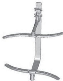
Подвижные форсунки необходимо чистить регулярно, иначе накипь и отложения жесткой воды засорят форсунки и каналы для воды. Для этого открутите гайку, снимите верхнюю часть подвижного механизма и затем снимите форсунку. Вымойте форсунки в теплой мыльной воде и используйте мягкую щетку для чистки отверстий. После промывки установите их обратно.
